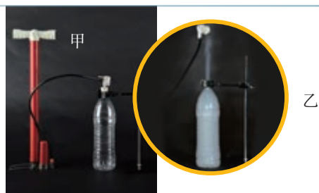
图 3.1-4 观察橡胶塞跳出时瓶内的变化
