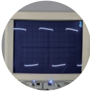
丙 电子电路中的矩形脉冲
