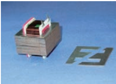
图2.3-5 用硅钢片做变压器的铁芯
