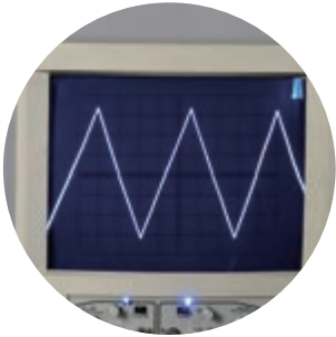
乙 示波器中的锯齿形扫描电压
