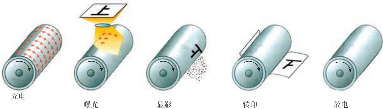
图 9.4-9 静电复印的工作流程
