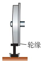
图 6.4-1 火车车轮有突出的轮缘
