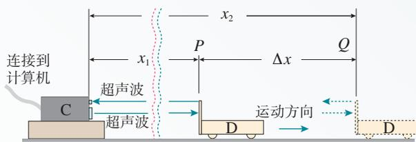
图 1.3-7 另一种位移传感器测速度的原理
