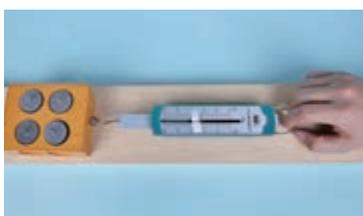
图 3.2-4 测量静摩擦力的实验装置
