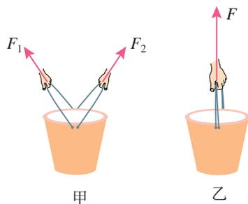
图 3.4-1 水桶所受拉力示意图
