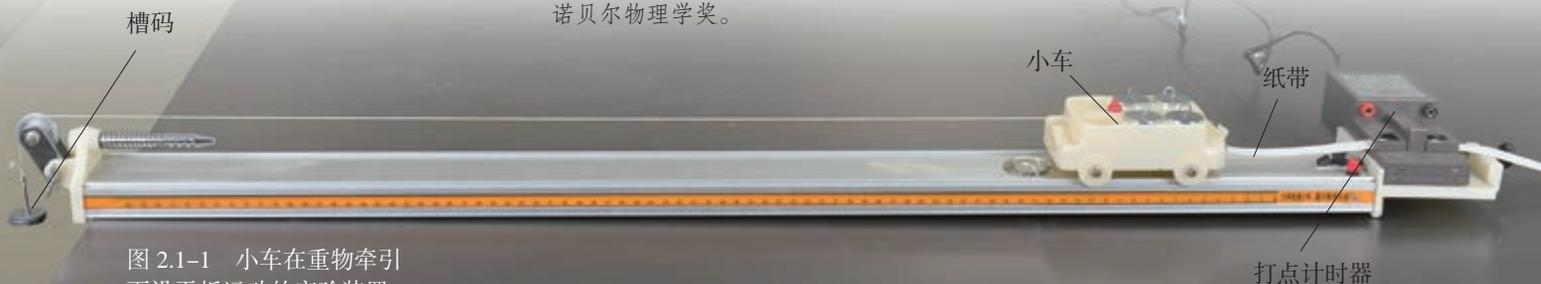
图 2.1-1 小车在重物牵引下沿平板运动的实验装置
