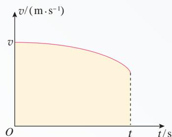
图 2.3-5 位移等于  $v-t$  曲线下面的面积
