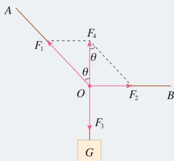
图 3.5-3 绳索连接点受力示意图
