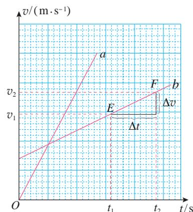
图 1.4-2 从  $v-t$  图像看物体的加速度
