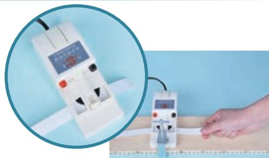
图 1.2-8 使用电火花打点计时器
